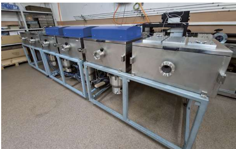
Dans ce prototype, quatre chambres sous vide sont placées côte-à-côte pour réaliser plusieurs dépôts d'affilée, et sont encadrées par des modules de chargement et de déchargement des pièces. Photo Surcotec
