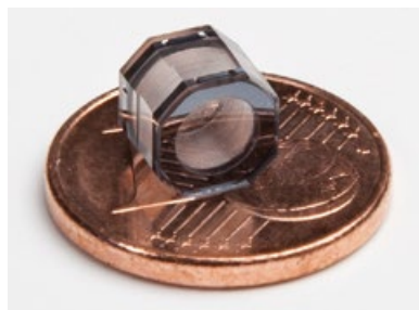
Microcellule au rubidium équipant le cœur de l'horloge atomique miniature, posée sur une pièce d'une centime d'euro. La dimension intérieure de la cellule est de 4 mm. Photo LTF / UniNE
