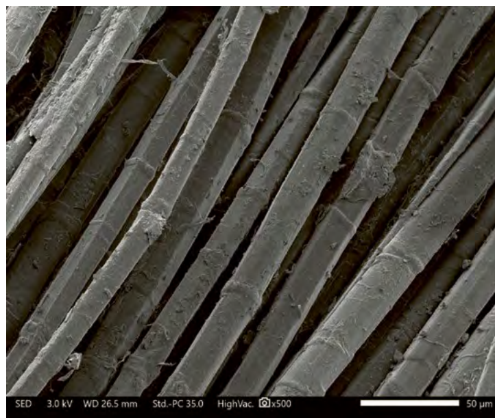
Fibres de lin anciennes vues au microscope électronique à balayage. © Alain Bourmaud, IRDL
