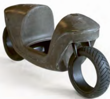
L'un des développements de SSUCHY, en partenariat avec la société NPSP BV, concerne un chassis de scooter monocoque en composites biosourcés avec renforts en chanvre pour remplacer les chassis traditionnels composés de nombreuses pièces plastiques et métalliques.
