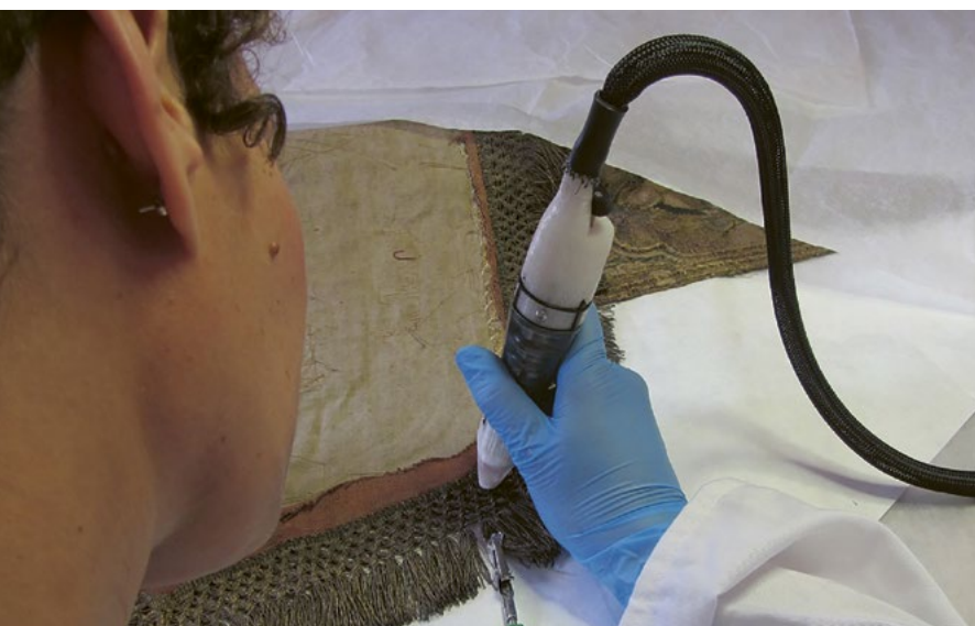
Nettoyage localisé, à l'aide du pinceau électrolytique Pleco, des fils métalliques du chaperon d'une chasuble du XV e siècle du Musée des tissus de Lyon. Photo Christian Degrigny Détail des fils métalliques avant et après nettoyage. Photos Stéphanie Ovide
