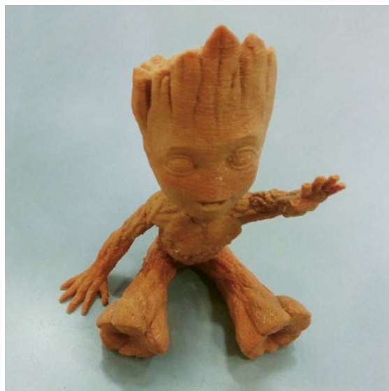
Figurine réalisée en impression 3D avec un filament chargé en bois. UTBM Innovation Crunch Lab
