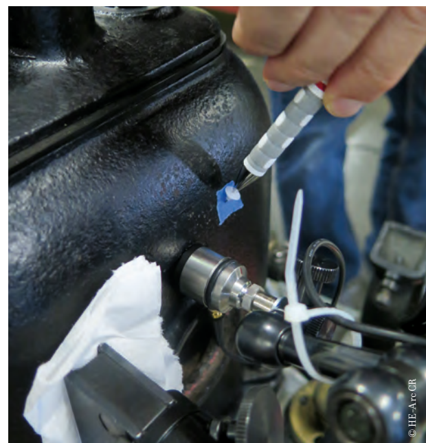
Fixation d'un capteur sur un moteur ancien pour analyse vibro-acoustique
