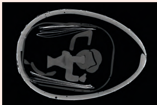
Coupe tomographique d'un œuf surprise Kinder, révélant aussi bien les différents matériaux que le vide à l'intérieur de l'œuf
