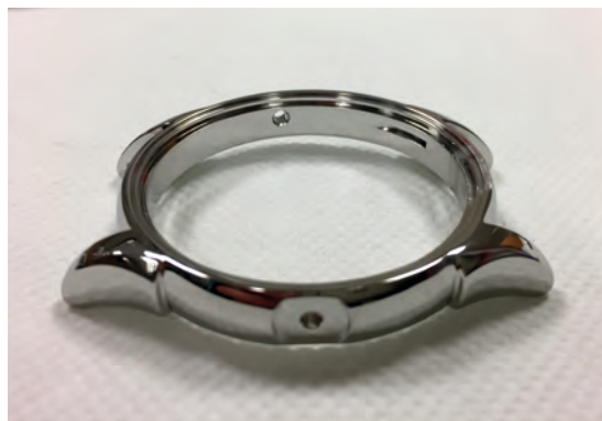
Carrure de montre en acier inoxydable 316L après électropolissage
