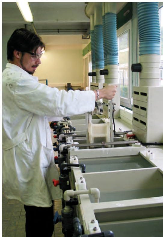
Chaîne de traitement de surfaces
